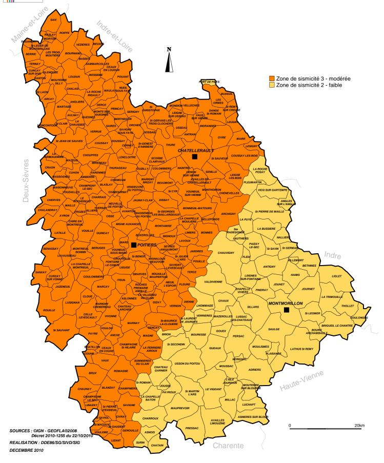
Délimitation des zones de sismicité conformément au décret 2010-1255 du 22 octobre 2010
